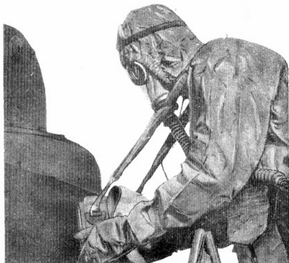
Abb. 2a Durchführung der Strahlungskontrolle mit dem Radiometer RR66
