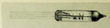
Bild 2-36 Relaisröhre Z 71 U [Val] in Subminiaturtechnik (ungesockelt mit zwei gleich- wertigen Startern, mit niedrigem Scheinwiderstand im Tonfrequenz- bereich, zur bevorzugten Verwendung in Schaltkreisen automatischer Telefon- zentralen
