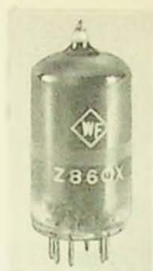
Bild 2-35 Relaisröhre Z 860 X [WF] mit 9-Stift- Sockel, mit Reinmetall- katode, für Gleichspan- nungsbetrieb zur vorwiegen- den Verwen- dung in Relais- und Zählschal- tungen
