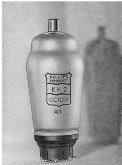
KK 2, die neue Mischröhre der 2-Volt-Batterieserie. Sie eignet sich sowohl für die normalen Rundfunkbereiche wie für Kurzwellen.
