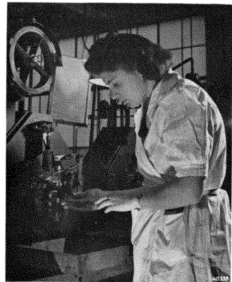
Fig. 67 Machine, waarop kleine draadjes ter bevestiging van elektroden worden geknipt en gebogen.
