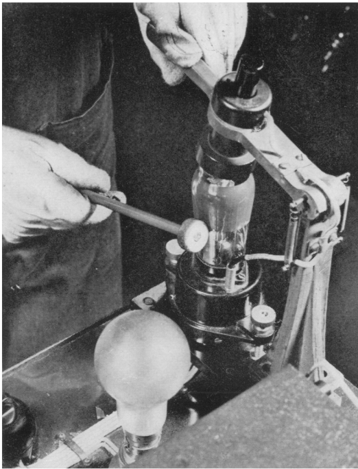
Das Prüfen einer fertig montierten Röhre auf Kurzschluss durch Anklopfen.
