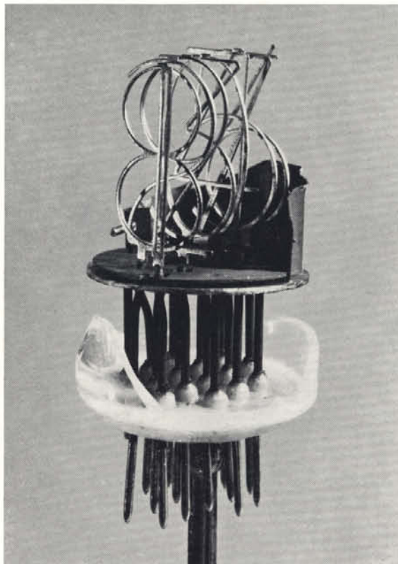
Bild 1. Systemaufbau der Ziffernanzeigeröhre ZM 1000. Das Anodenblech und das Anodengitter sind entfernt. Man erkennt die Anordnung der einseitig eingespannten ziffernförmigen Katoden.
